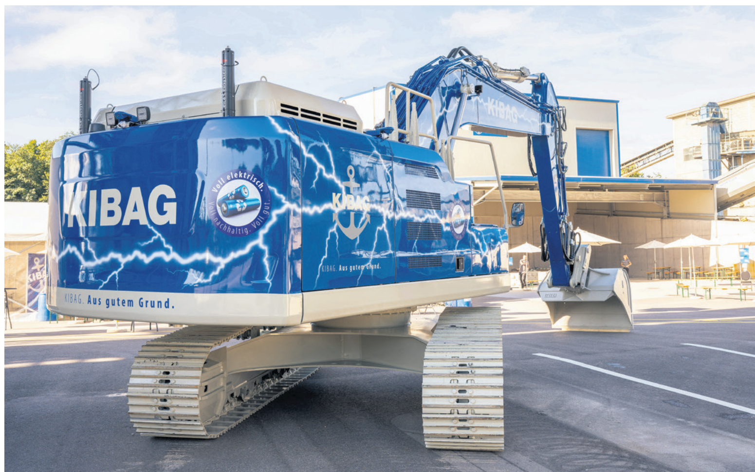
Der europaweit erste vollelektrisch betriebene 23-Tonnen-Raupenbagger ist seit letztem Jahr in Betrieb.
