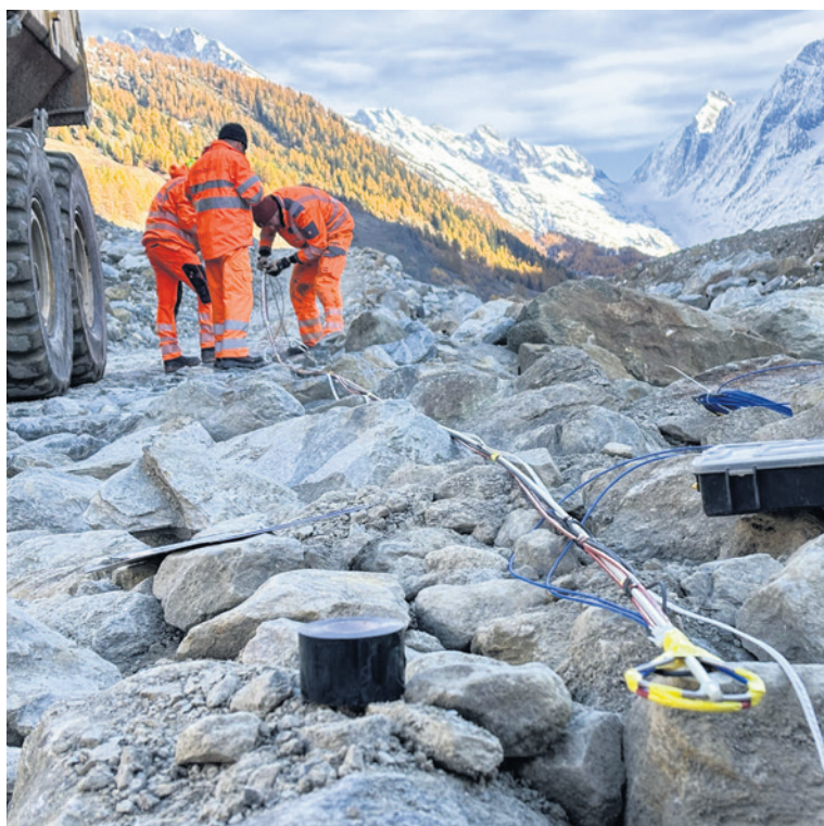
Im Schuttkegel von Blatten bereitet ein Team Messungen im Untergrund vor. Sensoren sollen zeigen, wie sich das eingeschlossene Gletschereis erwärmt. Bild: zvg
