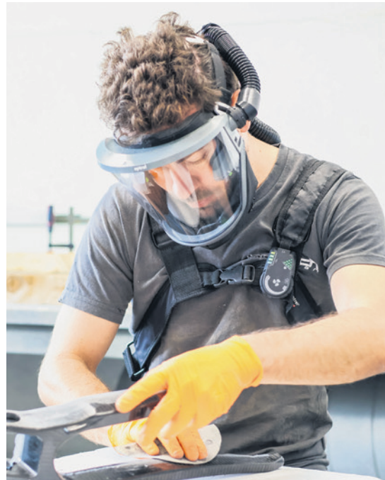
Bei der Herstellung eines Carbon-Bauteils sind viele Arbeitsschritte nötig. Dazu gehören das Formen und die sorgfältige Bearbeitung von Hand. Bilder: zvg
