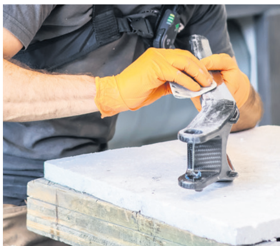
Bei der Herstellung eines Carbon-Bauteils sind viele Arbeitsschritte nötig. Dazu gehören das Formen und die sorgfältige Bearbeitung von Hand. Bilder: zvg
