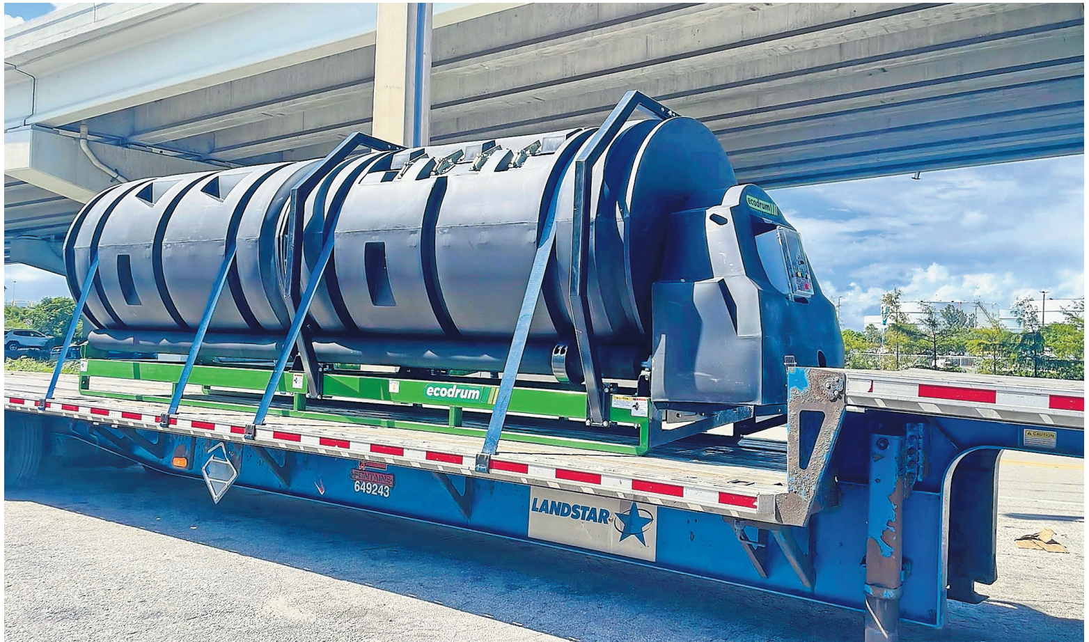
Die Anlage «Compost Cycle» wird ausgeliefert. Sie verwandelt organische Abfälle direkt im Betrieb in Kompost. Bilder: zvg
