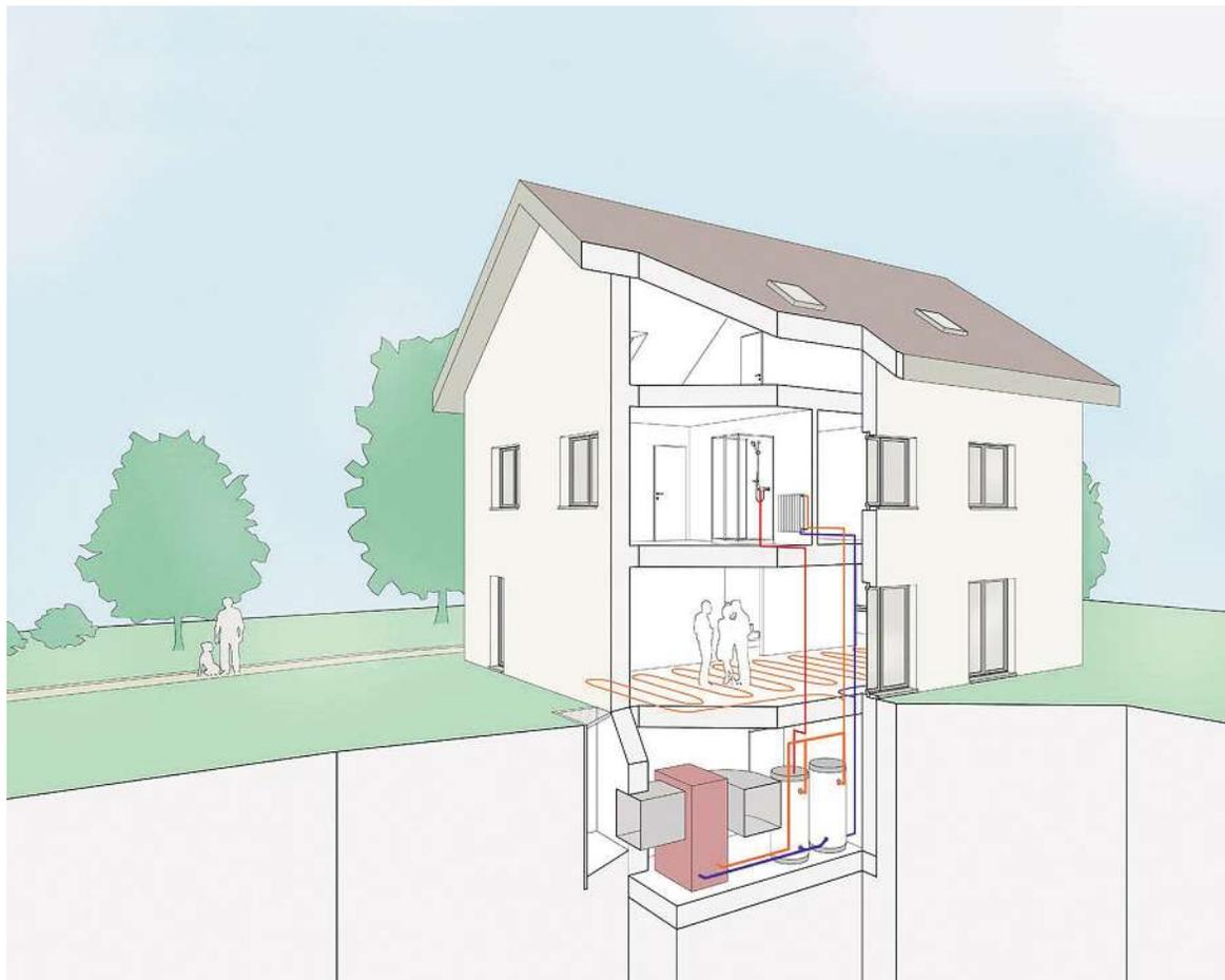
Eine Wärmepumpe mit Luft/Wasser ist ideal bei niedrigen Vorlauftemperaturen des Heizwassers.
